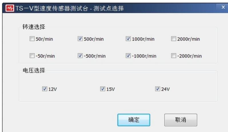
选择所需测试的转速及电源电压，点确定。点击开始测试按钮，弹出测试参数输入对话框：
