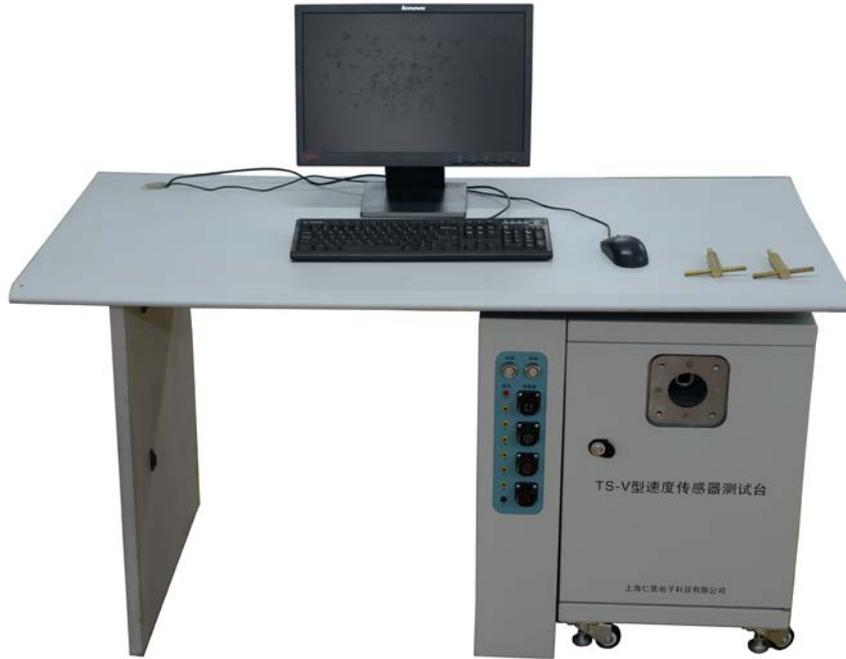
TS-V 型速度传感器测试台主要部件有桌架、控制箱、转动箱、计算机和打印机共 5 部分。
