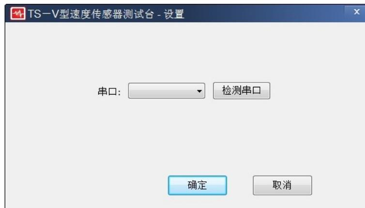
选择测试台所使用的串口，如串口列表中无所需串口，点击检测串口按钮，设置完成后点击确定，退出设置界面。
