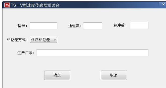
输入传感器型号，传感器的通道数，传感器的脉冲数、相位差方式和生产厂家后，点击确定，传感器信息添加完毕。
