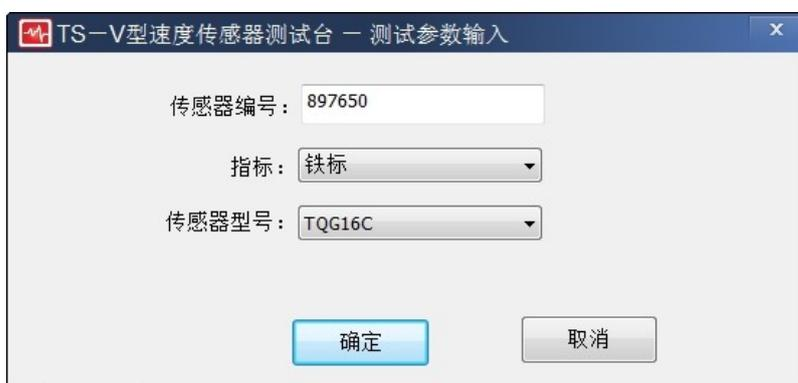
在对话框中输入传感器编号，选择传感器所使用的指标和传感器的型号，输入完毕后，点击确定，程序开始自动测试。测试时，程序自动保存测试记录、自动判断测试结果。
