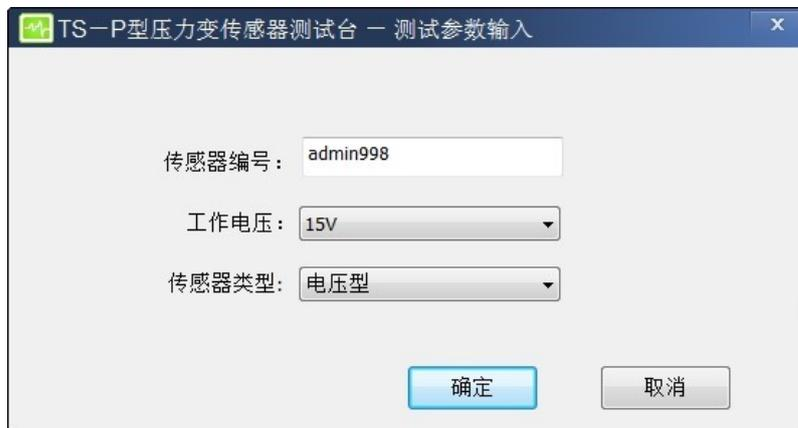
在对话框输入传感器编号，选择工作电压和传感器类型，点击确定按钮，开始测试。
