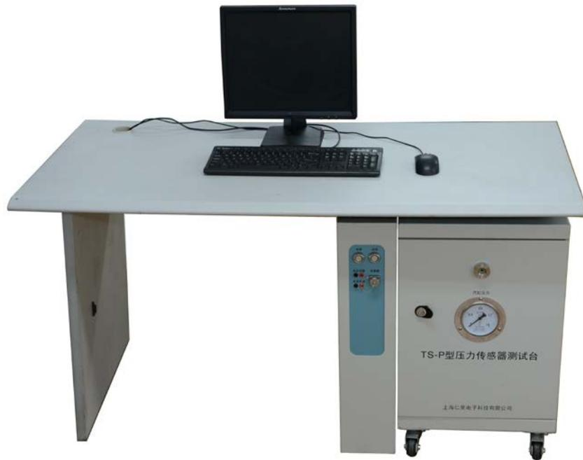
TS-P 型压力传感器测试台主要部件有桌架、控制箱、气压箱、计算机和打印机共 5 部分。
